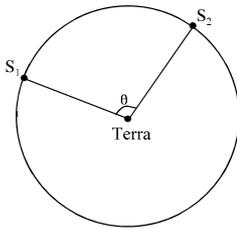
Dois satélites —  $S_1$  e  $S_2$  — estão em uma mesma órbita circular em volta da Terra, a uma distância de 21.000 km da superfície terrestre, conforme ilustra a figura acima. Considere que os dois satélites estejam a uma mesma velocidade constante em relação à Terra, que  $\text{sen}(\theta) = \frac{\sqrt{3}}{2}$
